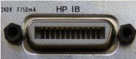
*Bild 2a: GPIB (HPIB)-Schnittstelle*
