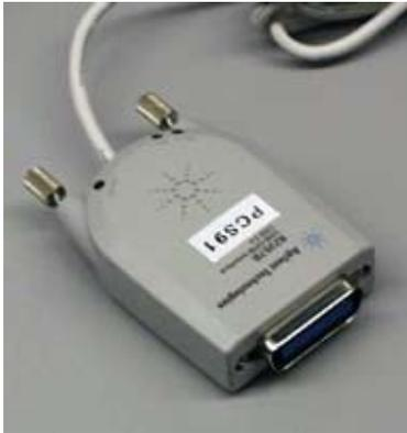
*Bild 5: USB-GPIB-Adapter
