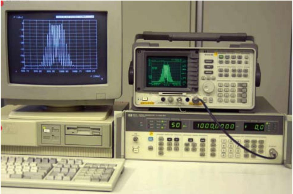
*Bild 6: Auslesen der Messdaten eines T-Gerätes und Darstellung mittels Rechner*
