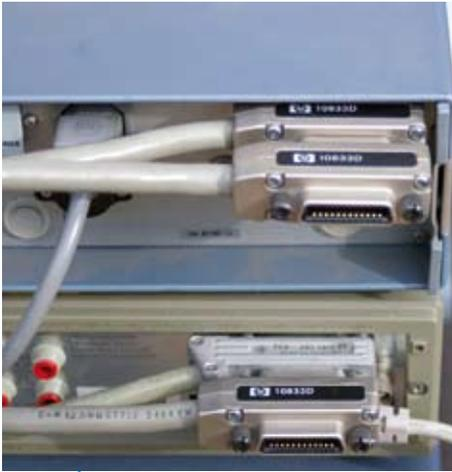
**Bild 3b: Detailaufnahme der Huckepack-Steckverbinder**
